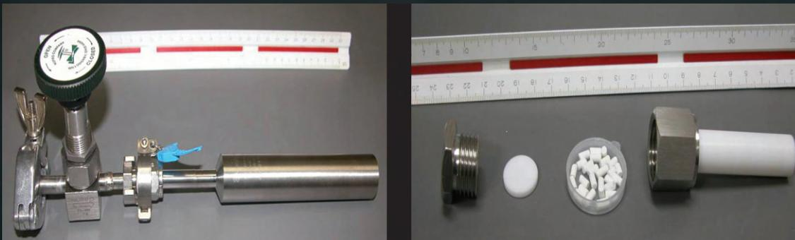
A la izquierda, la ampolla que se utiliza actualmente para la recolección de  $\text{UF}_6$ . A la derecha, el material empleado para la recolección y el transporte por el método “ABACC-Cristallini”.
