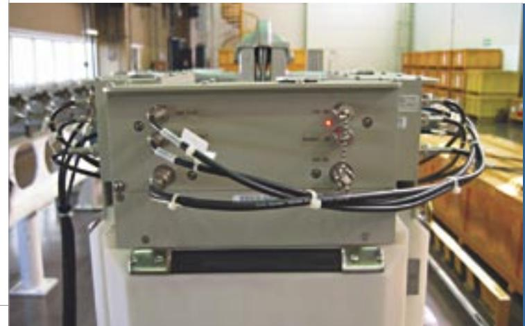
Montagem do colar de nêutrons na usina de fabricação de elementos combustíveis de Conuar
